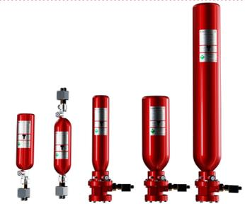
Unidades especiais de contêiner HRD, equipadas com uma válvula de abertura rápida e outros acessórios. Eles mantêm o extintor sob pressão constante. Se uma explosão for detectada, elas garantem a indução imediata e eficaz do meio de extinção no equipamento protegido. A vantagem é a variabilidade do tamanho da unidade de contêineres HRD (8, 20 ou 50 litros), supressão rápida e eficaz de explosão em sua fase inicial, fácil manuseio e manutenção simples.
